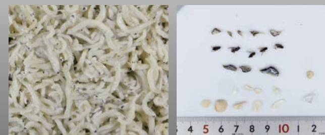
製品 Accept 排除品 Reject 釜揚げシラスの異物除去 Foreign material Rejection of Baby Sardine
