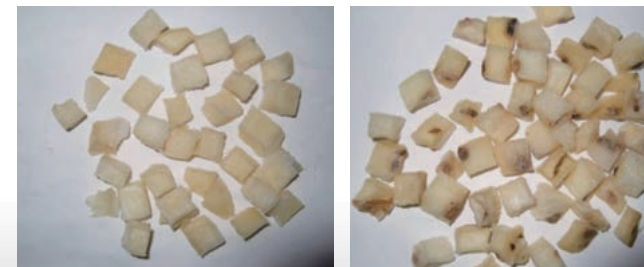
製品 Accept 排除品 Reject 角切りポテトの外観検査 Inspection of Diced Potato
